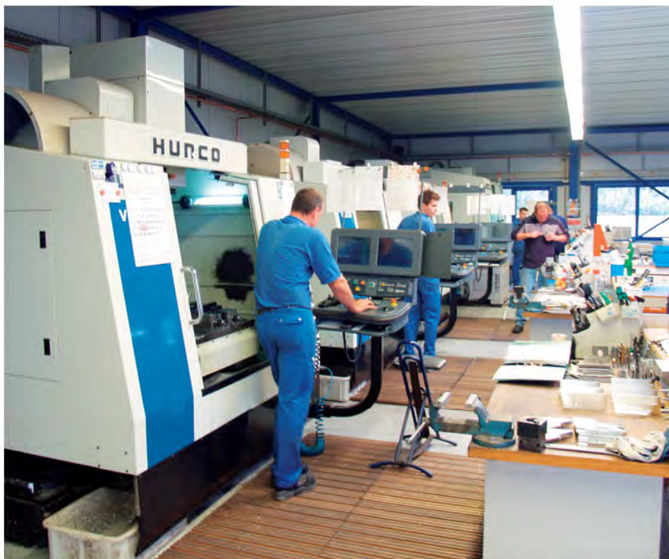
2 Grundlage der Fertigung bilden bei TBA drei »VMX 24« und eine »VMX 50« von Hurco, die ausgesprochen gut zur Unternehmensstruktur und -strategie passen
